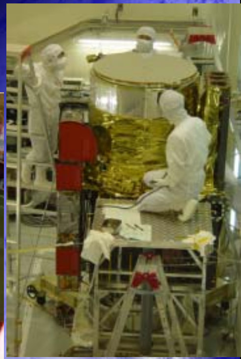
試験中の可視光・磁場望遠鏡(国立天文台クリーンルーム)
