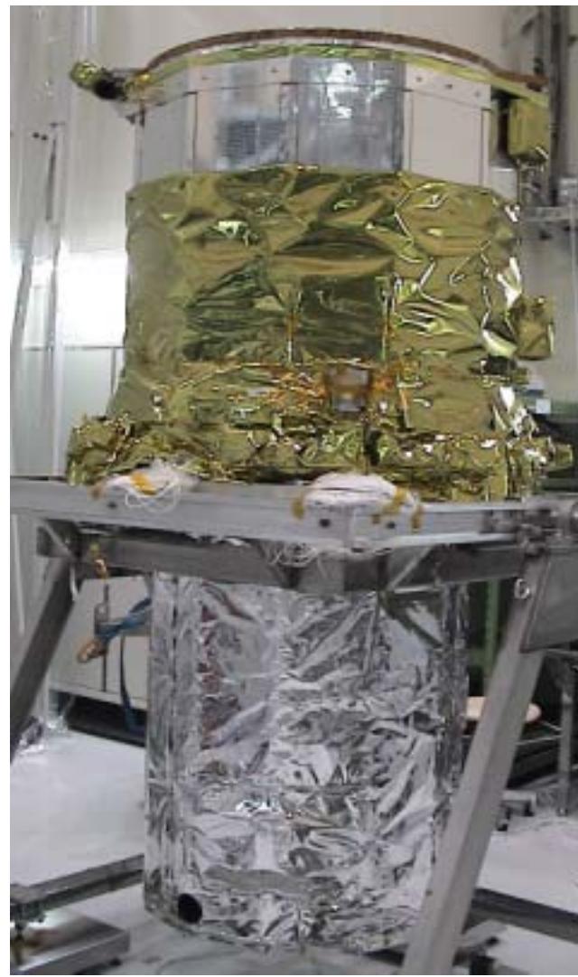
MLIで覆われて最終形状となっ た可視光望遠鏡
