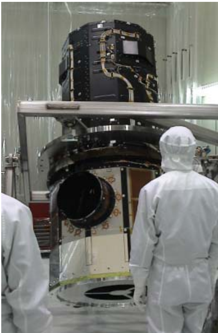
温度センサー、ヒーターケーブル など、最後の外観確認
