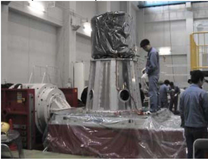
望遠鏡単体振動・衝撃試験(宇宙研・30トン加振機)
