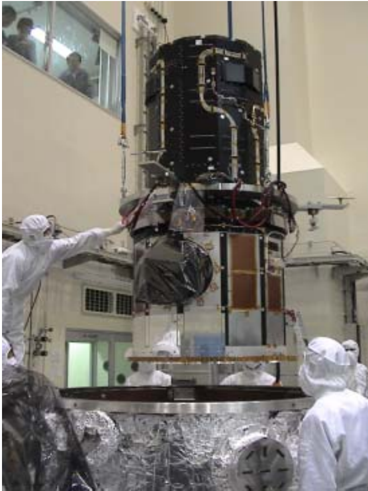
完成一步前の可視光望遠鏡は逆さにして真空チャンバーに設置(国立天文台・クリーンルーム)
