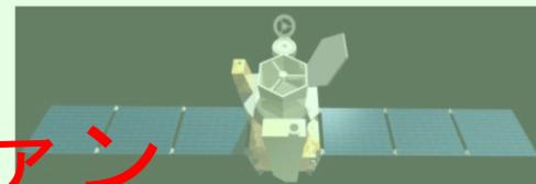
「Solar-B」は、ひのとり、ようこうに継ぐ日本で3番目の太陽観測衛星です。3つの最先端の望遠鏡を約6000度の太陽中心角(光球から約100万度以上の外層大気(コロナ)までの領域で、磁場・温度・プラズマの流れを高エネルギー・高解像度で観測を行い、高温コロナ、コロナ爆発現象や磁場とプラズマの相互作用などの謎の解明に取り組みます。
