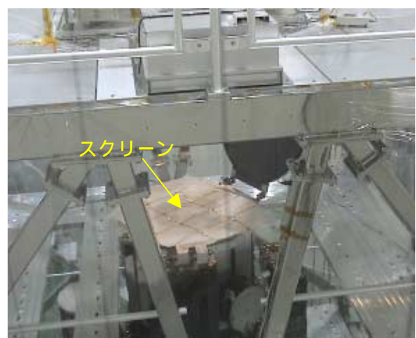
写真 4 . OTA 内部を照らすため開口に散乱用のスクリーンを置く。
