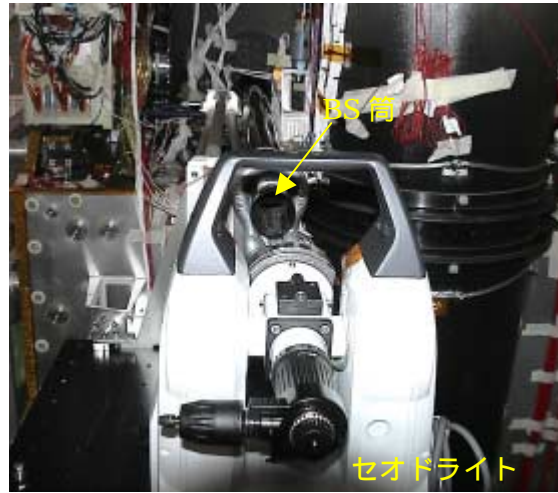
写真 7 .セオドライトによるアライメント測定。
