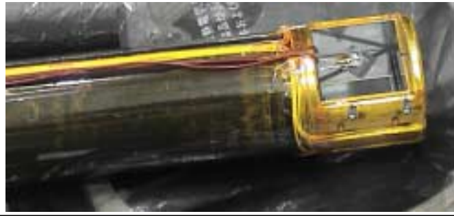
写真 6 .OTA-FPP 間アライメント測定用のビームスプリッター。FPP 側の面には発光ダイオードが取付けられている。
