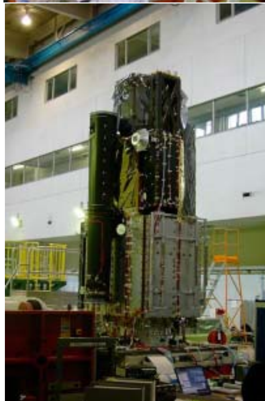
図:1 宇宙科学研究所の振動試験設備に据え付けられた Solar-B 構造試験モデル
