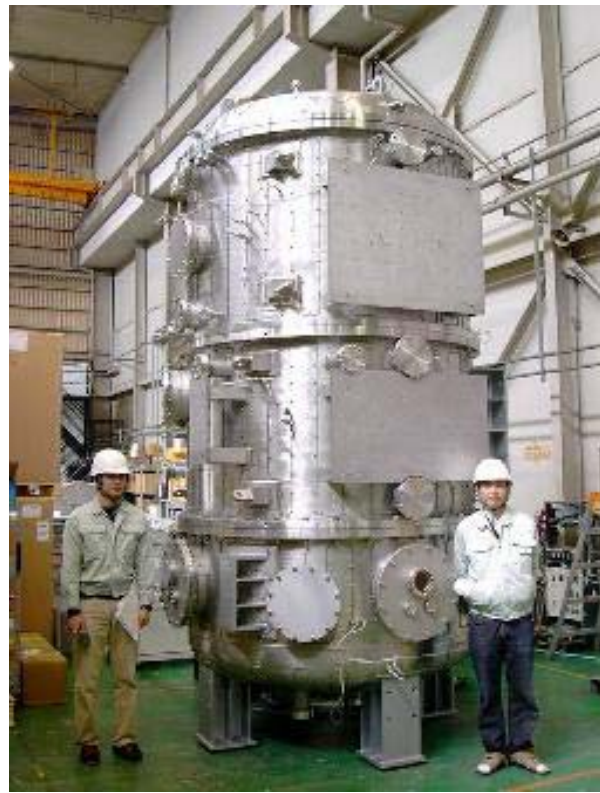
図 8:熱光学試験真空チャンバー
