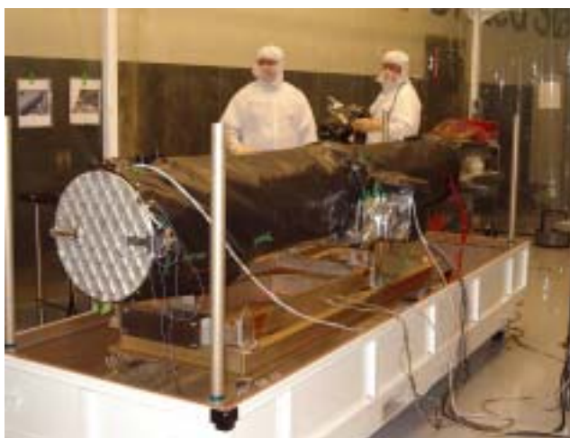
図 2 . 真空槽に搬入される Solar-B の X 線望遠鏡
