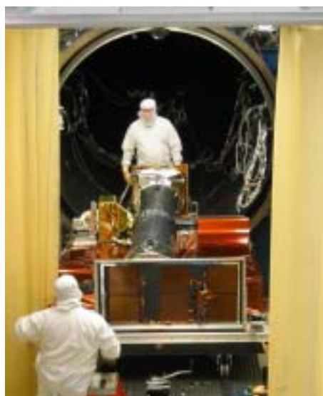
図 2 . 真空槽に搬入される Solar-B の X 線望遠鏡
