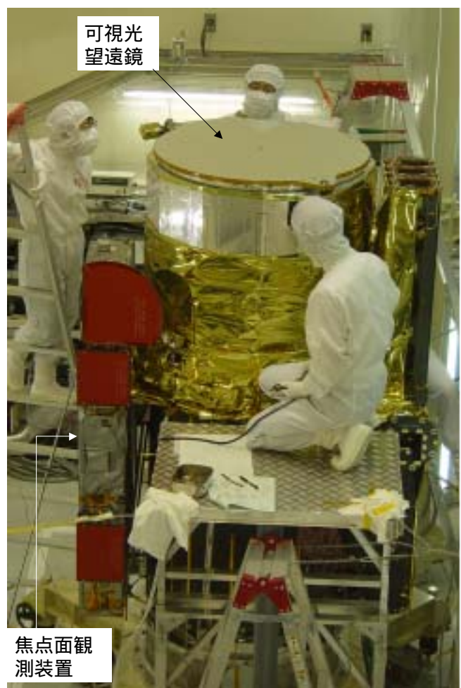
写真 2. 太陽光試験のため焦点面観測装置と結合された可視光望遠鏡。
