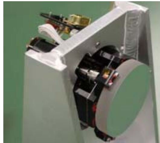
図 1: 可動鏡 (3本の piezo 素子で駆動される)
