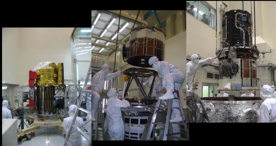
「ひので」可視光望遠鏡の組立・調整作業
