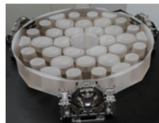
「ひので」可視光望遠鏡の口径50cm軽量化ULEガラス主鏡と3点静定支持機構。SOLAR-Cでは90%近い軽量化構造、ストレスフリーの支持機構を実現します。
