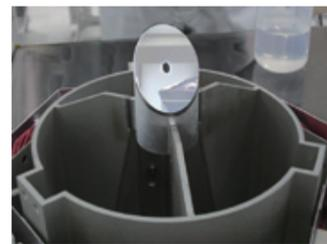
「ひので」可視光望遠鏡の1次焦点排熱鏡。アルミ鏡に銀増反射コーティングをほどこし、約5%の太陽光吸収率を実現。コーティングの耐久試験や鏡面の汚染管理によって1500ソーラーの光が集中する排熱鏡の温度を50℃以下に保つことができました。
